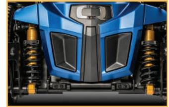
Mit der SRS-Federung kann der Edge 3 bei ausgefahrenem Sitzlift mit 5,6 km/h gefahren werden.
